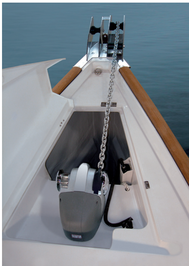
Alternativ dekksmontering: Vinsjen er montert på et horisontalt plan under en luke.
