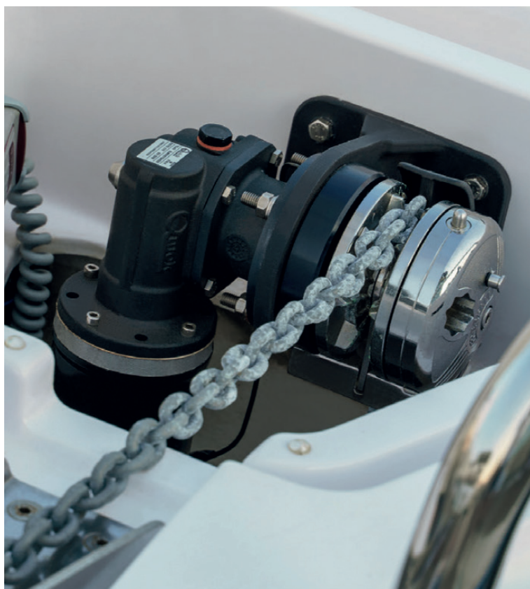
Ved skottmontering trekker vinsjen motsatt vei sammelignet med akterspeilmontering.
