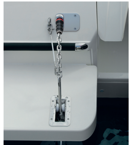
Vinsjen er montert direkte på innsiden av akterspeilet.
