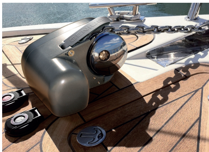
Quick Genius montert på dekk. Her er både motor og kabelar over dekk.
