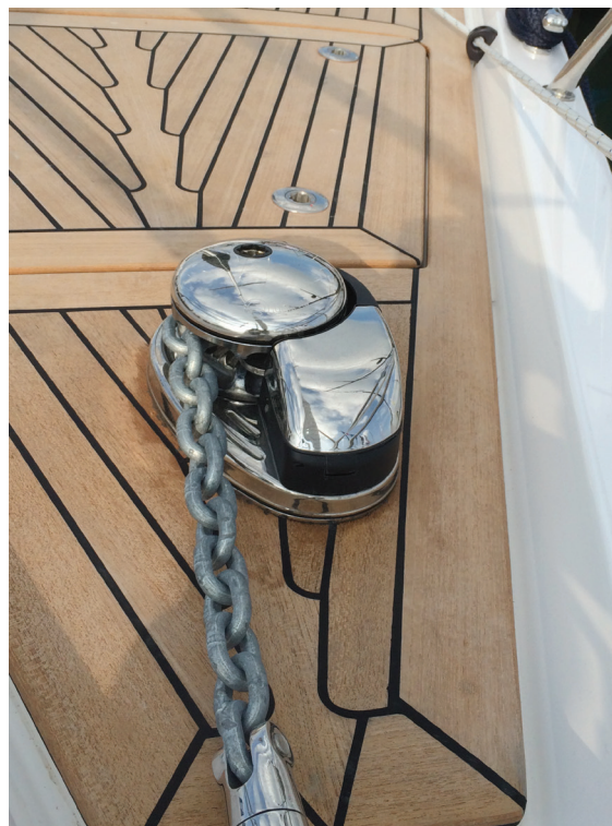
Her er en Quick Prince med underliggende motor. Kabelaret er over dekk, og motoren er under dekk.
