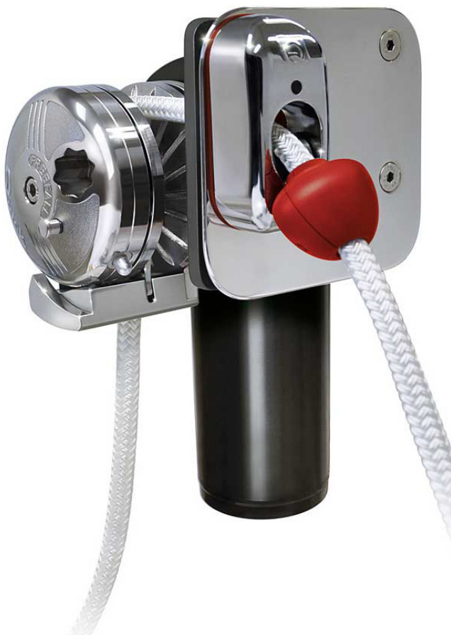
Modell X: Kabelaret står på babord side av vinsjmotoren
