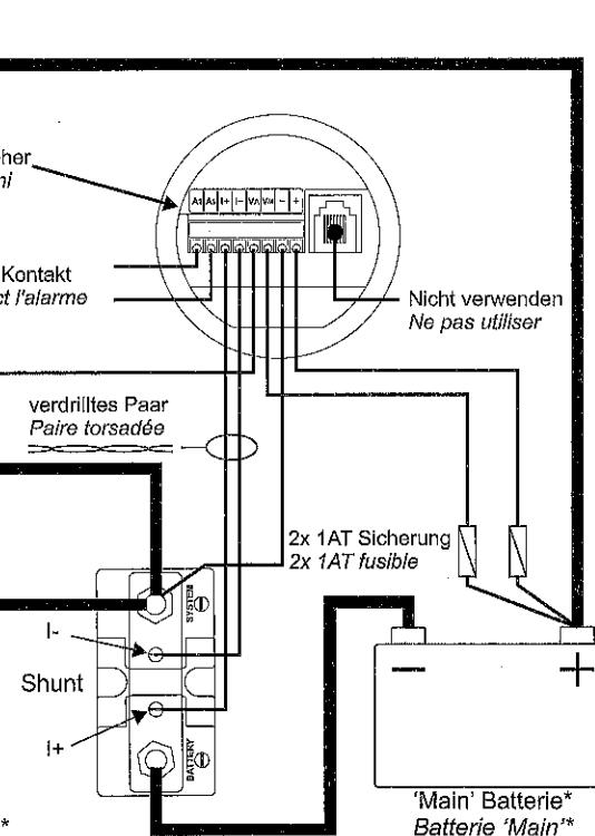
Le Shunt doit toujours être installé sur le **négatif** ( câble noir !) Installer le Shunt sur le positif ( câble rouge ), endommagerait le contrôleur de batterie!
