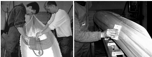
Fordel epoxyen ut mot kantene ved hjelp av plastsparkel eller pensel
