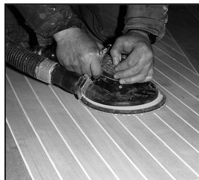
La epoxyen herde. Puss med sandpapir til man får en jevn og glatt overflate. Dekket settes så inn med ønsket overflatebehandling.
